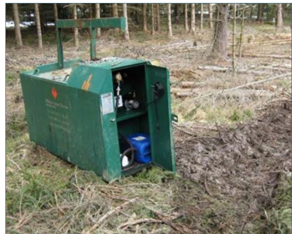
Abb. 5: Bsp. eines mobilen 1000-Liter-Dieseltanks Foto: WWA DEG
