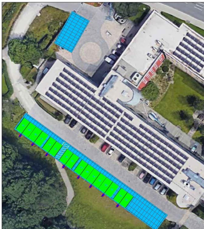
Vorplanung zum PV-Carport mit einem stufenweisen Ausbau der Ladeinfrastruktur
