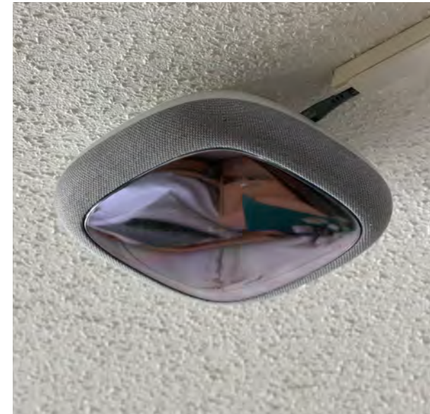
Mobile Sturzsensorik an der Zimmerdecke © Korian Stiftung für Pflege und würdevolles Altern
